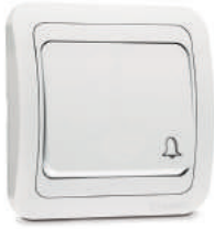
Bell Switch * 12050 10 A, 250 V~ EN 60669-1 Piece in Box / Package - 12 / 120
