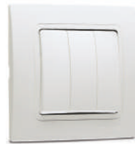
3 Gang 3 Pole Switch 31002092 10 AX, 250 V~ EN 60669-1 Piece in Box / Package - 12 / 120
